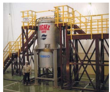
物質・材料研究機構材料研究所・神戸製鋼所のグループで開発中の 1GHz NMR 装置
