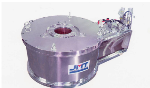
写真 ジャイロトロン用冷凍機冷却超電導マグネット 中心最大磁場 6.7T、ボア内径 140mm (写真提供 ジャパンスーパーコンダクタテクノロジー (株)、旧社名：ジャパンマグネットテクノロジー(株))
