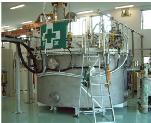
写真 負荷変動補償・周波数調整用 SMES 要素モデルコイルシステム
