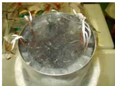
液体窒素浸漬試験状況
