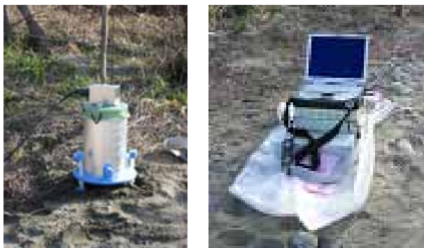
図2 開発した SQUID システム （左：センサ部、右：計測部）
