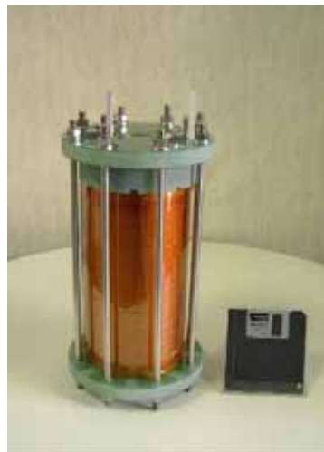
図 1 Y 系線材を用いて製作されたソレノイドコイル
