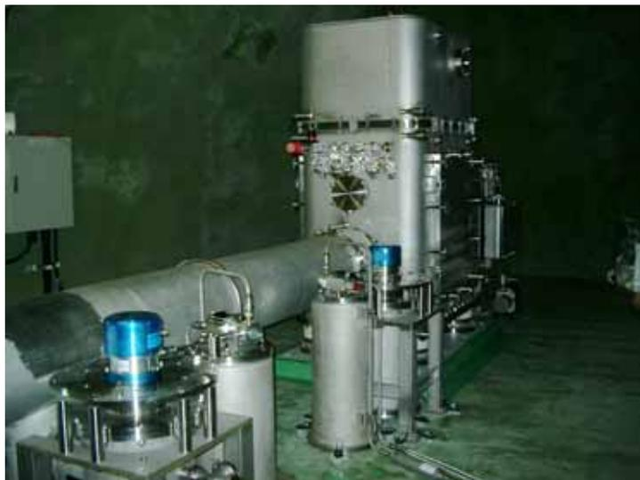
図 神岡鉱山地下に設置された重力波検出鏡冷却用 4K および 80K 低振動パルス管冷凍機システム
