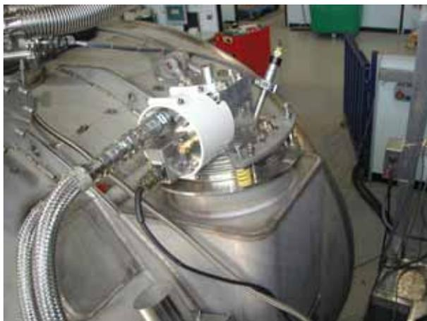
図3 4K GM 冷凍機付きマグネット（冷凍機縦置き、Siemens）
