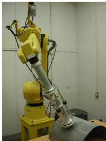
図 3 次元移動型 SQUID 非破壊検査装置
