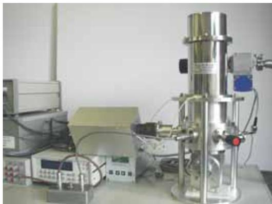
図1 産総研試作の液体ヘリウムフリー・ジョセフソン電圧標準システム・プロトタイプ
