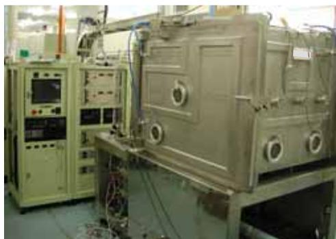
図 強磁場スパッタ装置(実用実験機)
