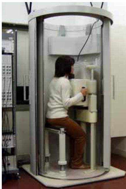
図1 高温超電導 16 チャンネル心磁計
