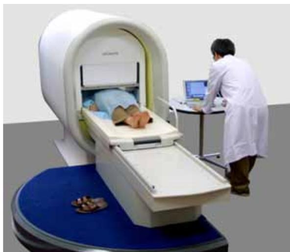
図2 高温超電導 51 チャンネル心磁計
