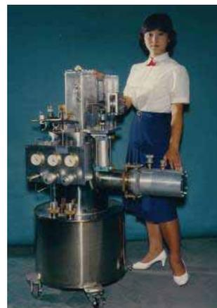
図1 駆動方式磁気冷凍機
