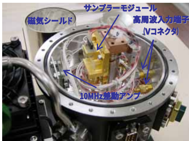
図 3 小型クライオクーラーを用いたサンプラー冷却システム（内部写真）
