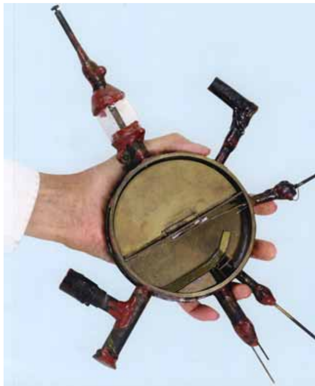
図 2-1 Lawrence が完成させたいかにも手作りという感じの手の平サイズの最初のサイクロトロン
