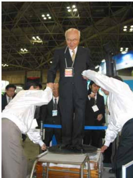
超電導大型バルクを使用しての浮上実験、体験者は ISTEC 荒木理事長
