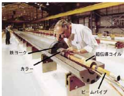
図 3-1 加速器用超電導磁石の例 (SSC 双極電磁石)
