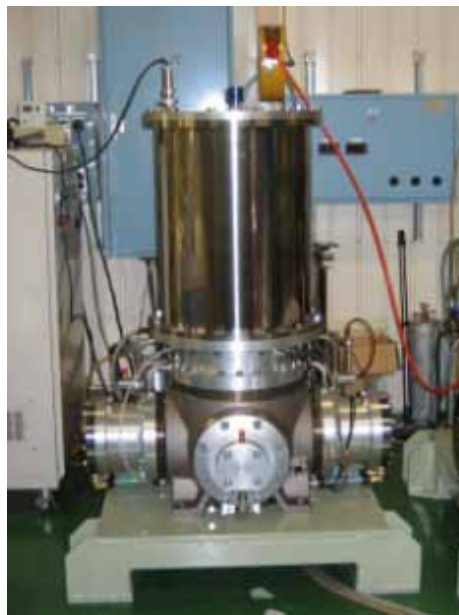
図1 20 K オイルレス冷凍機構造
