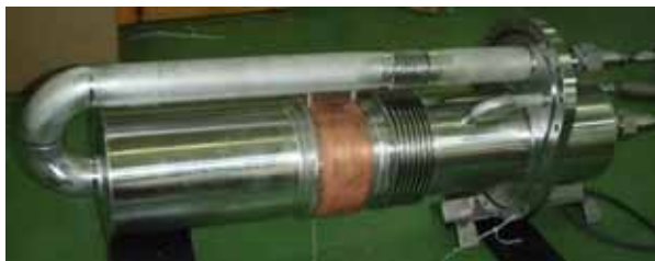
主変圧器実用型パルス管冷凍機（参考図）
