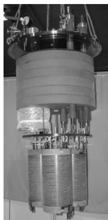
図1 三相分の限流コイル(左)、サブクール窒素冷却容器と冷凍機圧縮機(右)
