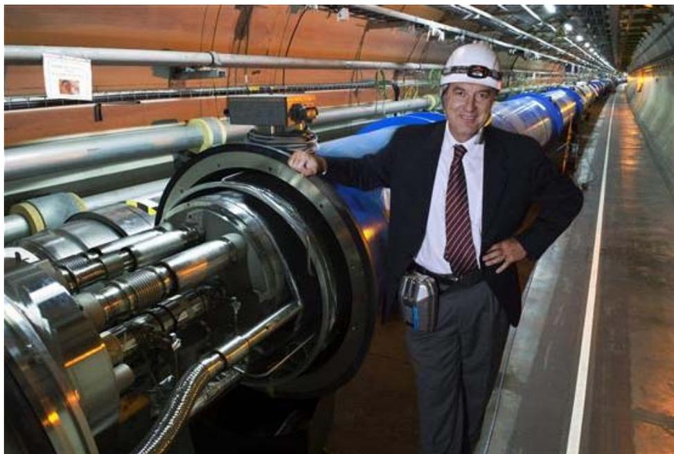
図 5-2 トンネル内に設置された超電導磁石群。(CERN 提供)
