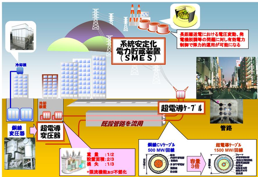
図 2 超電導電力機器による都市部への大容量安定供給の概念
