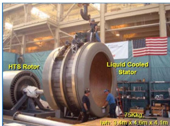
図1 組み立て中の36.5 MW船用モータ
