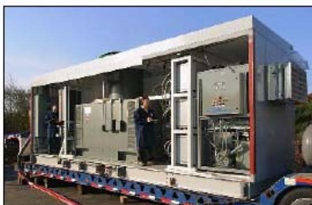
図2 HTS回転機を用いた同期調相機
