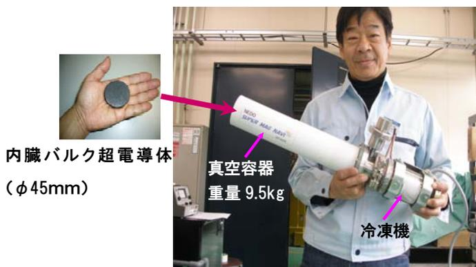
図 1 試作した超電導バルク磁石
