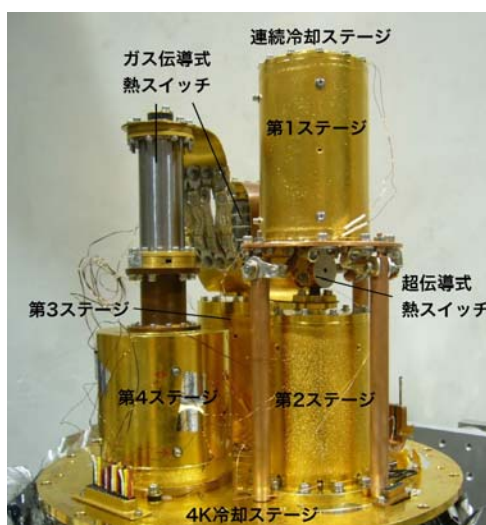
写真 1 4 段式連続型 ADR 装置：空間配置を最適化した実際の ADR 装置主要部。直径 30 cm、高さ 35 cm に納められている。
