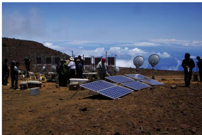
図 4: マウイ島の送電アンテナシステム、太陽電池で発電された電力をマイクロ波に変換して 8 台の小型アンテナから、遙か離れたマウナロア山に向けて送電
