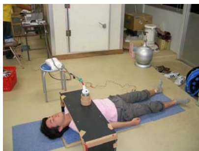
図 3 MSR 外で台の上にデュワーを置き計測した心磁図
