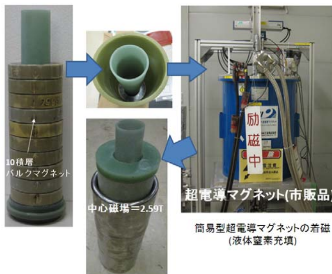
図 1 簡易型超電導マグネット
