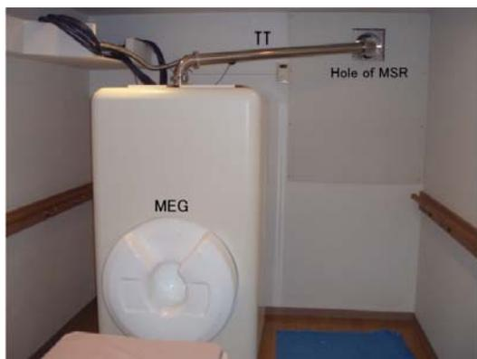
図2 名大医学部用HCS。TTは既設シールドの換気孔を通して室外に設置した冷凍チャンバに結合されるため約3mになった。
