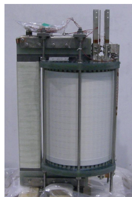
変圧器の外観 (φ200 mm、高さ 250 mm)
