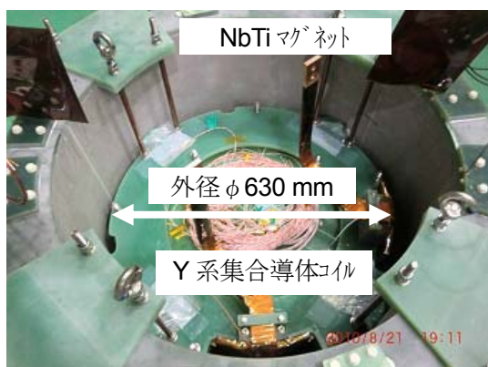
図 1 高耐フープ応力試験（NbTi バックアップマグネットに挿入された Y 系集合導体コイル、4.2K で実施）
