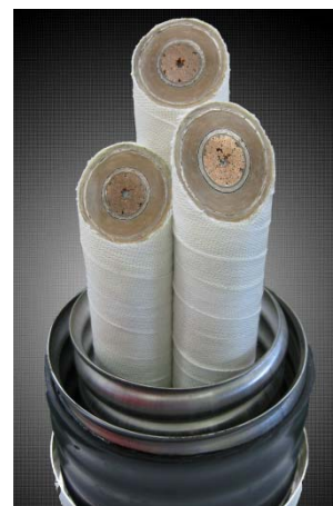
図 1 機械試作した三心一括型超電導ケーブルのサンプル
