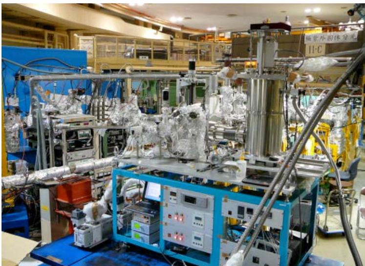
図 1 超伝導検出器を搭載した軽元素用蛍光収量 XAFS 分光装置
