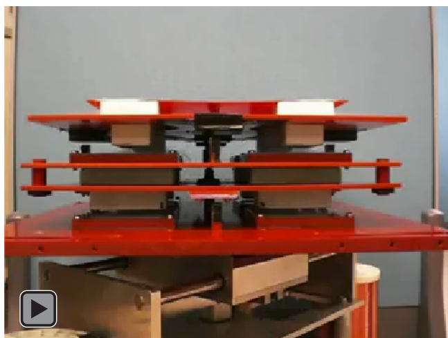
図 2 磁気浮上型超電導免震装置の免震効果（動画）
