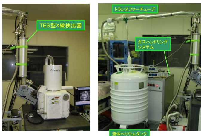
図 1 (左) : SEM に取り付けられた TES 型 X 線検出器の外観写真、(右) : 超電導 X 線検出装置の外観写真
