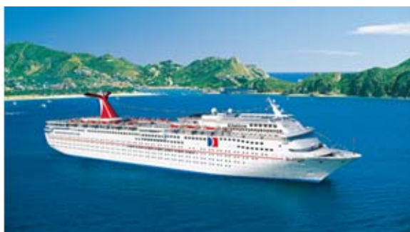
図3 電機推進船の例：7万トン級豪華大型客船“イレーション”42.8MWモータ装備。最新の電気推進システムを採用、モーター部分を船外に設置するという、極めて斬新な運航方式を取り、より船内を広く使えるエンジン配置になった。振動や騒音も大きく削減できた http://www.cruise-mag.com/db/profile.cgi?_v=1204176961&pl=view
