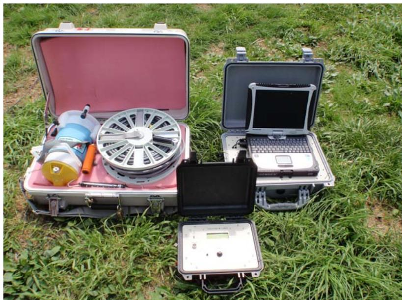
図4 開発中の SQUITEM3 号機。左奥は SQUID 磁力計、右奥は受信装置、手前は GPS 同期クロック。
