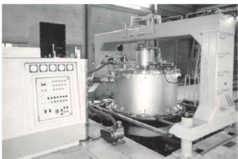
図2 超電導磁気浮上特性基礎試験装置
