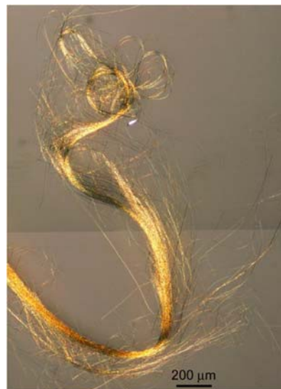
図1 フラーレンナノウィスカーは、フラーレンを原料にした糸状の結晶で、さまざまな長さのものが作製できる。
