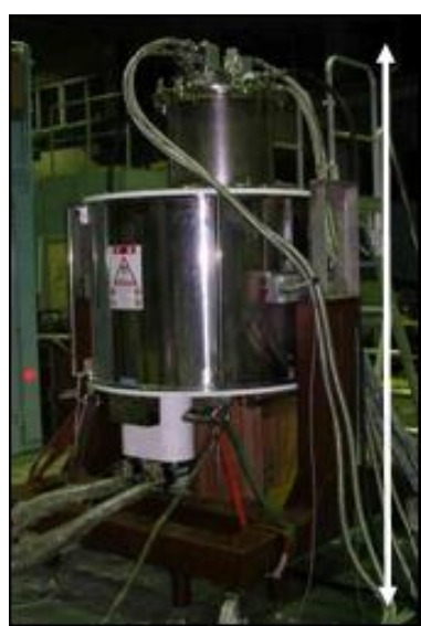
図 1 高温超電導線材評価試験装置
