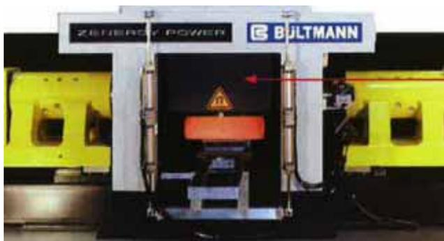
図6 実用化された超電導加熱炉。実験のため銅を赤熱するまで加熱した。
