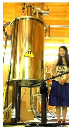
図 1 世界初の ReBCO-NMR コイル。左 -ReBCO コイル、右-これを内装した NMR 全体。600 MHz-14.1 T
