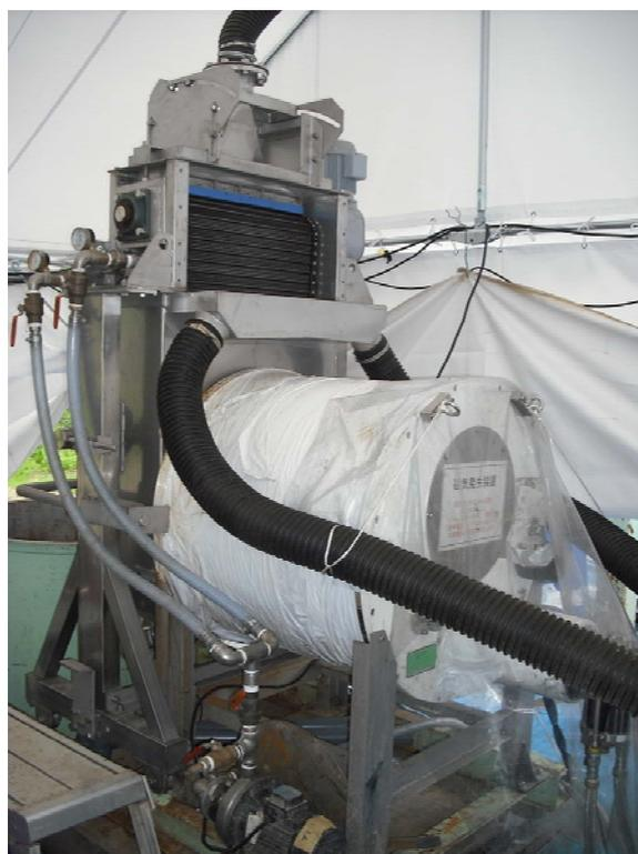
図1 飛灰の除染に利用された超電導磁石システム
