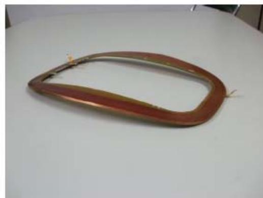
図4 加速器用の高精度三次元変形コイル。
