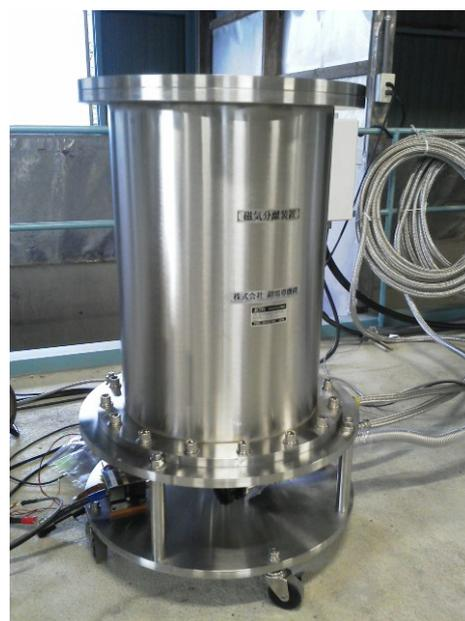
図2 磁気アルキメデス法に利用された超電導磁石
