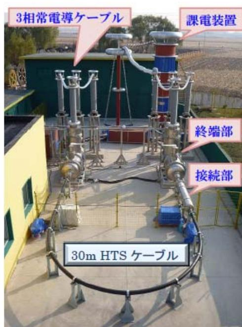
図 4. 275 kV - 3 kA 高電圧ケーブル検証用システム概観
