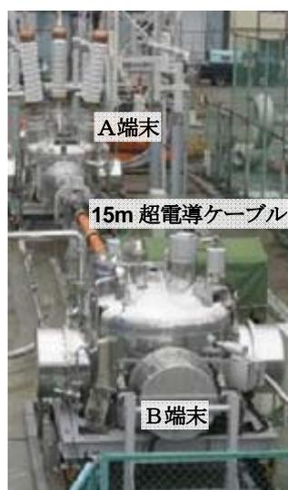
図 2 66kV/5kA 級大電流ケーブルシステム (住友電工 熊取試験場)
