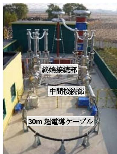
図6 275kV/3kA 級高電圧ケーブルシステム
