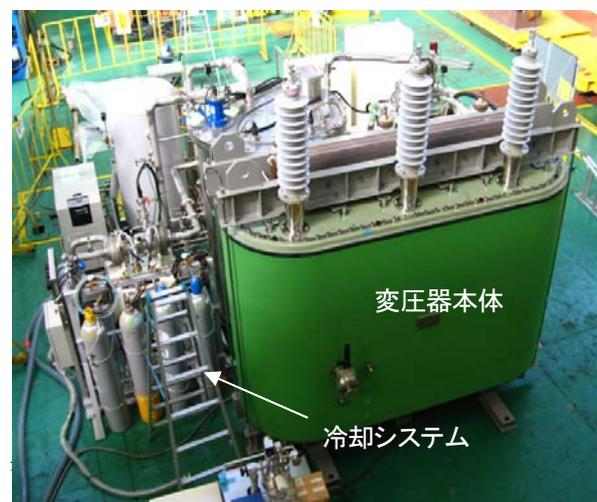
図4 2 MVA変圧器モデルの外観
