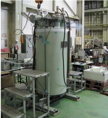
図2 2 kA 級大電流巻線モデルの試験状況
