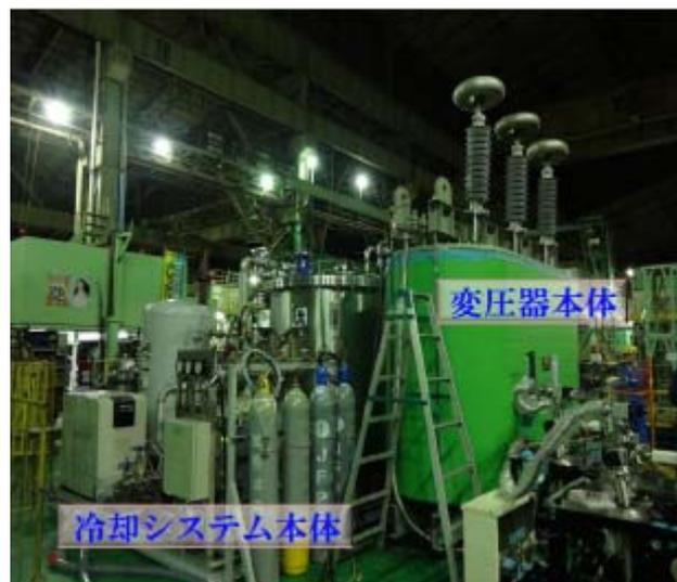
図 5. 冷却システムと組み合わせた 2 MVA 級超電導変圧器モデルシステム概観
