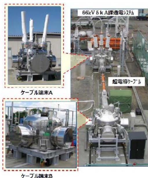
図3. 66 kV -5 kA 大電流ケーブル検証用システム概観
