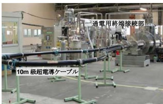
図 4 66kV/5kA 級大電流ケーブルシステム
