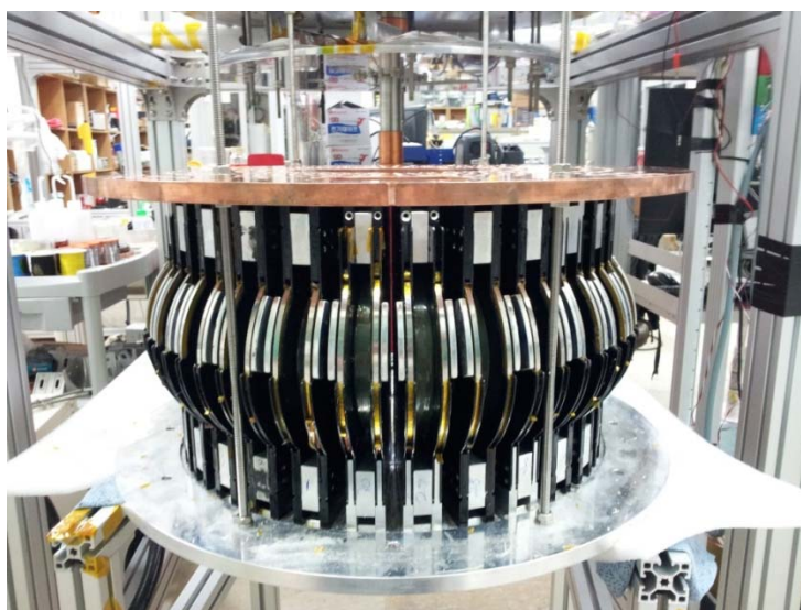
図 2 400 mH 400 A 級直流リアクター高温超電導コイルの外観写真
