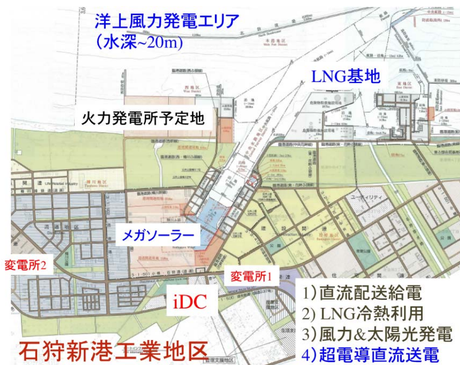
図1 石狩での超電導直流送電を中心にしたスマートグリッド構想
