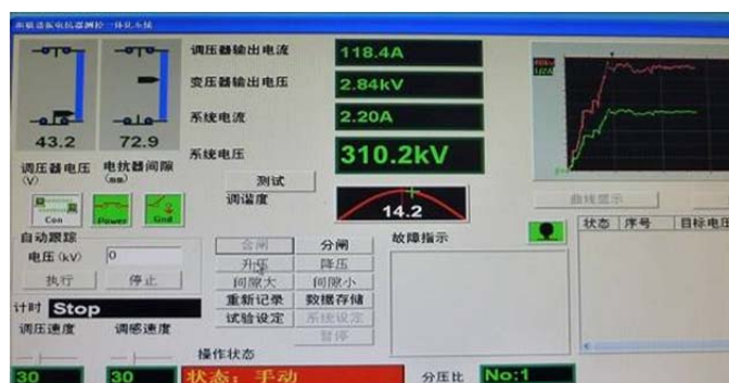
図 4 部分放電試験の通電トランスの画面と部分放電信号
