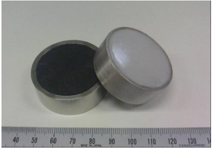
図 1. SMA リングで補強されたバルク体 (左: 樹脂コート無し、右: 樹脂コート有り)。
