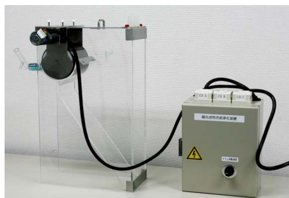
図 2. 5 L 標準磁化活性汚泥装置
