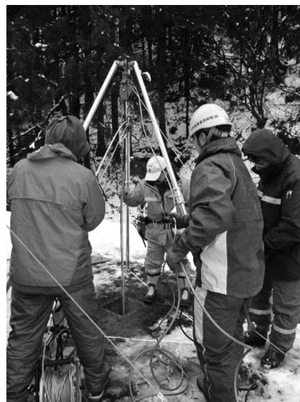
図 2. 鋼管ケーシング入り試験孔中に SQUID 磁力計を投入している様子。
