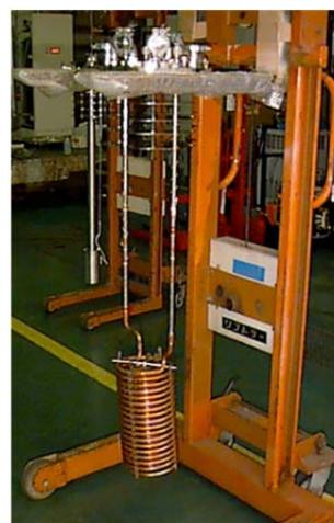
図 4-3 サブクール熱交換器
