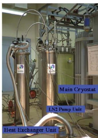
図 4-2 オープンサイクル冷却システム
