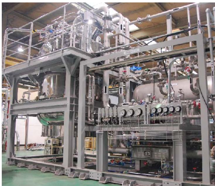
図2 旭変電所での実証試験を予定している5 kW級ブレイトン冷凍機
