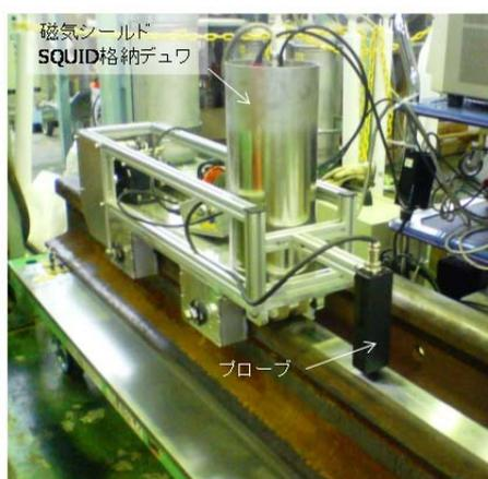
図1 SQUID-レール検査装置
