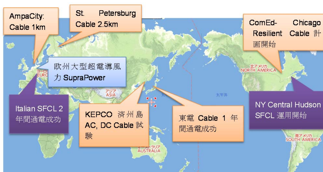
図 1 再生可能エネルギーに関係する代表的な高温超電導プロジェクト。 風力の SupraPower-Pj を除いて、他は全て系統試験である。SFCL:超電導限流器。
