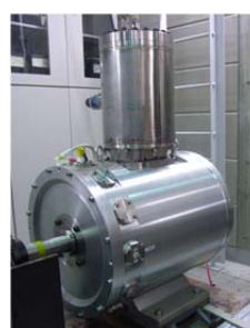
20 kW 級プロトタイプ高温超伝導モータ
