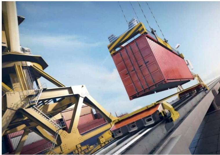
MAGLEV のCG 一部。船舶からコンテナを受け取り、下のパレット状の車両が高速で輸送する。
