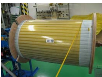
図4 スクライビング線材 (上) と特殊巻線工程
