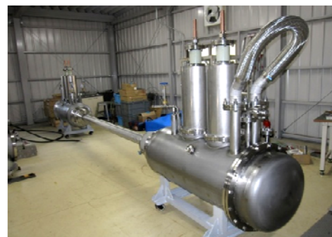
図3 8 kA 級鉄道用超電導ケーブル
