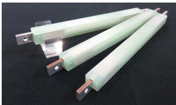
図 1 開発した 500 A 級超電導電流リードの外観
