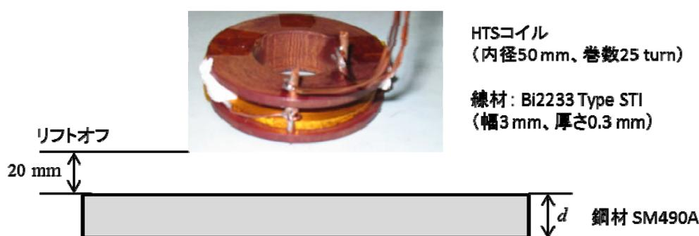
図1 HTS コイルを用いた鋼材厚さの計測
