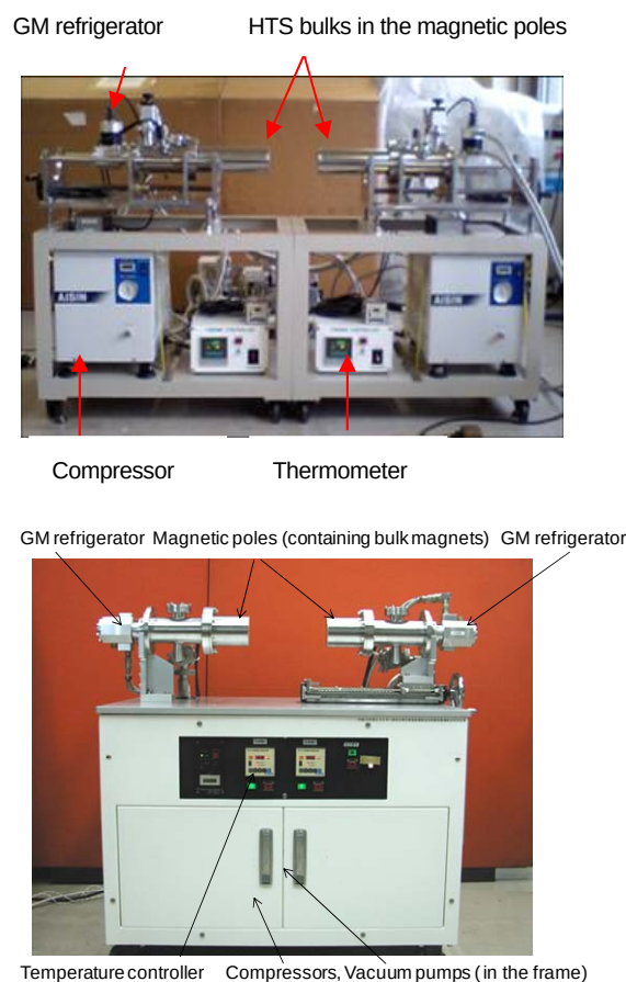
図： 対向型バルク磁極装置 FC 着磁型（上）とパルス着磁型（下）
