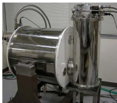
図 10 T 級超電導マグネットと 4 K 級 L 字型伝導冷却試験装置
