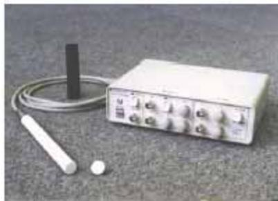
写真 1 高温超電導 SQUID キット(住友電気ハイテックス製)
