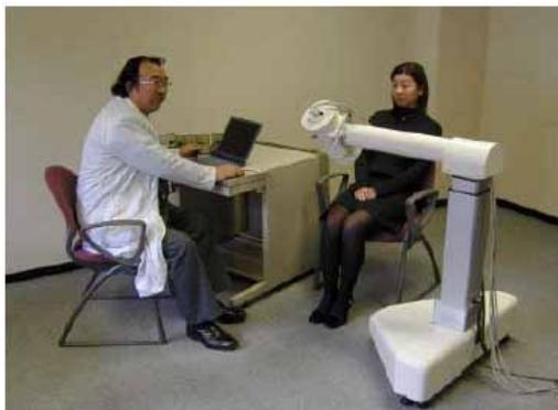
写真 2 磁気シールドなしで心臓磁場診断が可能な高温超電導 SQUID を用いた心磁計
