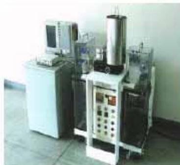
写真 5 銅線中铁微粉混入検査装置
